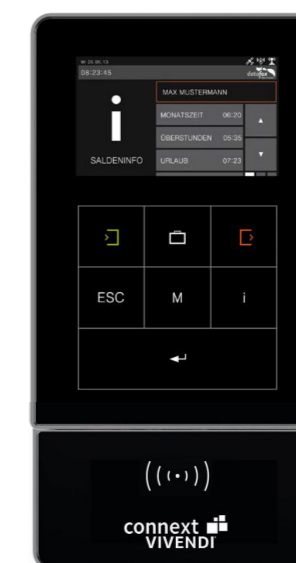
Elektronisches Zeiterfassungsterminal: Die Personalzeiten werden direkt an VIVENDI® übertragen und ausgewertet.
